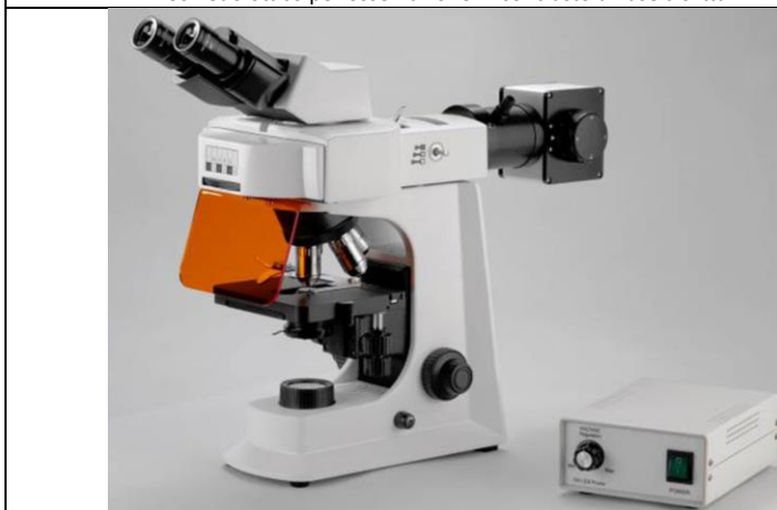
Dispositivo a fluorescenza fino a 4 filtri con lampada a LED o HBO
