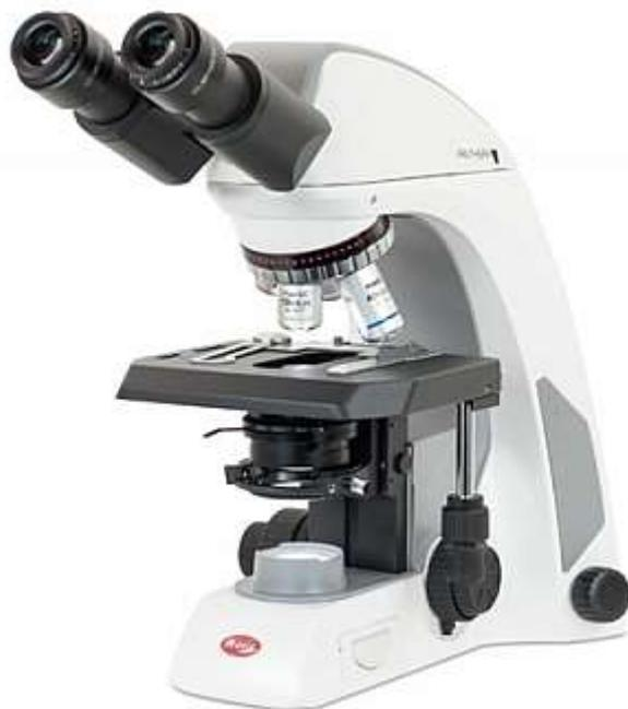
Stativo microscopio Panthera U in alluminio pressofuso ad elevata stabilità meccanica dotato di porta USB di alimentazione per camere digitali o altri dispositivi elettronici
